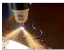
Perçage sur tôle acier doux 2 mm
