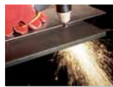
Coupage de tôle 10 mm avec le PC210
